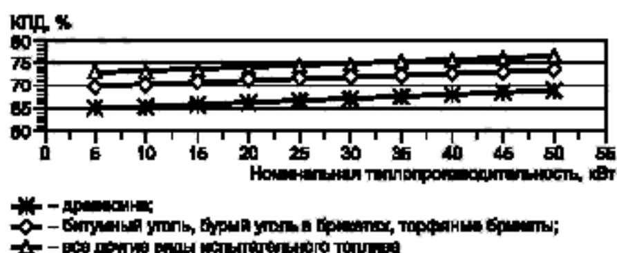
Рисунок 1 — КПД при номинальной теплопроизводительности
