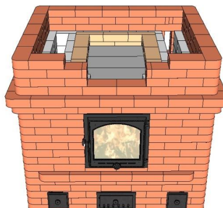
Фото 10. Строительство двадцатого ряда печи
