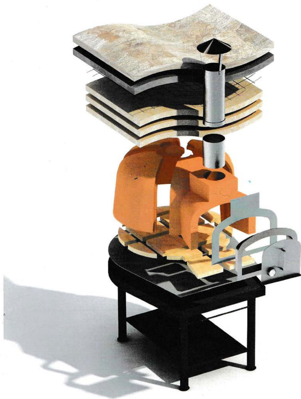
Рисунок А.7 – Схема сборки керамической дровяной печи
