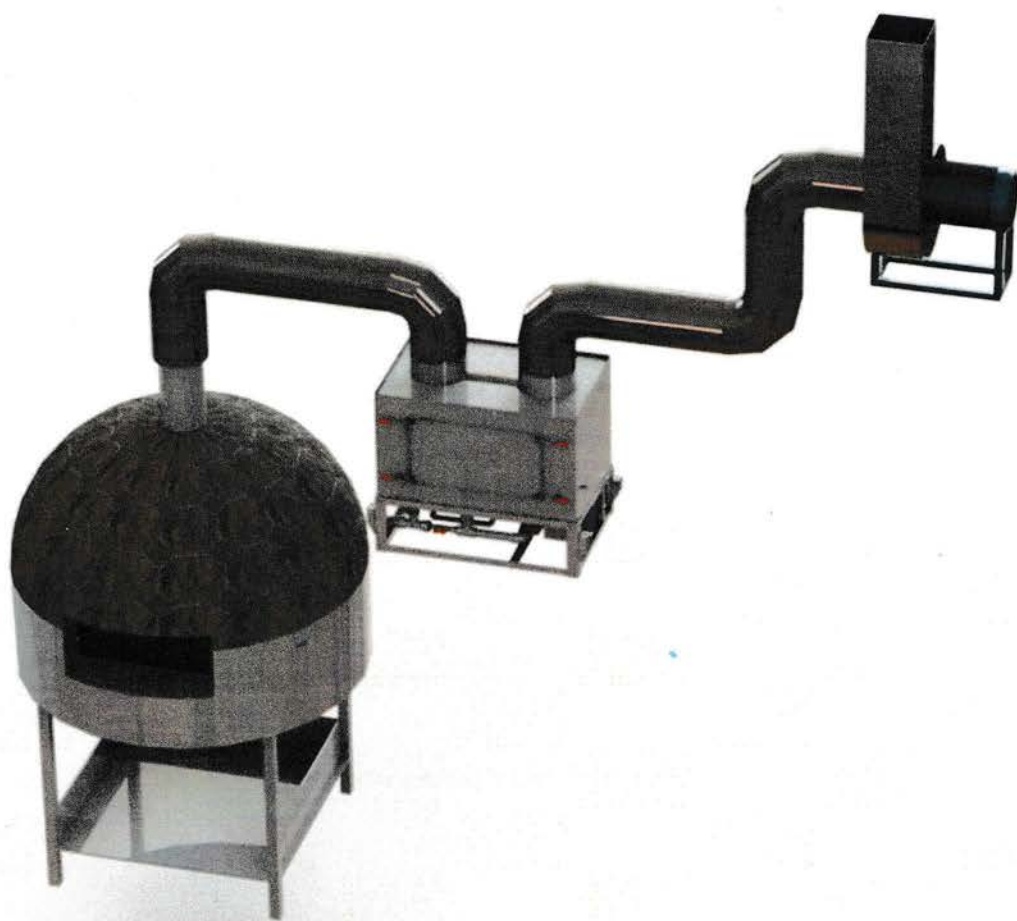
Рисунок А.3 – Общая схема подключения гидрофилтра к воздуховоду
